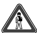
**Elektrik gerilimi yüklü bağlantılarından elektrik çarpması sonucu hayatı tehlike mevcuttur. Cihaz üzerinde çalışmaya başlamadan önce elektrik girişini kesiniz ve tekrar açılmamasını emniyet altına alınız.**
