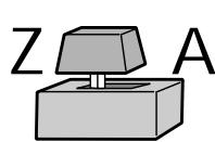
Zweipunkt-Regelung (Werkseinstellung) ist erforderlich, wenn die Leistung des Heizgerätes deutlich über dem errechneten Wärmebedarf liegt (z. B. um eine größere Warmwasserleistung zu erzielen).
