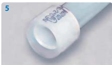
5 Установите кольцо Q&E на конец трубы так, чтобы оно выступало за край трубы на 1 мм
