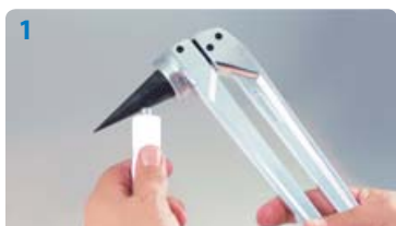
1 Смажьте конус инструмента графитовой смазкой Uronor
