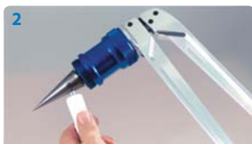
2 Прикрутите к расширительному инструменту насадку-вращатель. Смажьте конус насадки-вращателя графитовой смазкой Uronor
