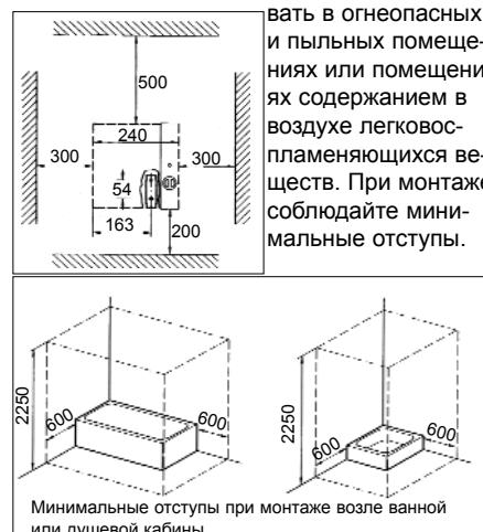
Монтаж осуществляется в соответствии с рисунками. Следите, чтобы монтажная планка располагалась строго вертикально. Открутите защитный винт с язычка на приборе. Навесьте прибор на планку, сначала снизу, потом сверху. Прикрутите защитный винт на место. Включите сетевой штекер в розетку с заземлением. При желании прибор можно подключить стационарно к электросети.
