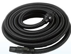
**Всасывающие шланги с обратным клапаном** применяются в качестве входной магистрали поверхностных насосов. Шланги армированы пластиковой спиралью. На одном конце шланга — обратный клапан с фильтром, на другом конце — разборный соединительный фитинг для соединения с насосом. Материал шланга — ПВХ
