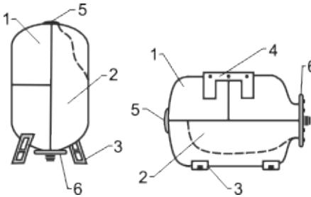
Гидроаккумулятор состоит из стальной емкости (бака) – (1), внутри которой находится резиновая мембрана (2). Внутренняя полость мембранны соединена с напорной магистралью через фланец (6), а в полость между внешней поверхностью мембранны и внутренней поверхностью емкости под давлением закачан воздух.
