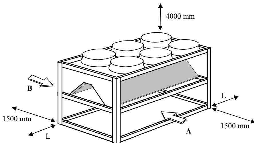
La completa accessibilità dai lati 'A' e 'B' indicati in figura permette di effettuare le operazioni di normale manutenzione anche con macchine affiancate ( $L=0$ ). Ove possibile, si consiglia di mantenere comunque una distanza minima  $L=1000$  mm tale da consentire interventi di manutenzione straordinaria sulle batterie alettate.
