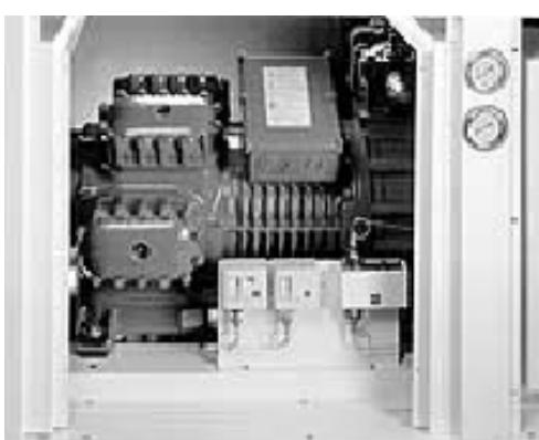
Tutti i modelli di refrigeratori CSAC-CSAF hanno due circuiti frigoriferi indipendenti, quindi sono in grado di funzionare almeno al 50% della potenza in caso di anomalie ad un circuito. Il motore è a 4 poli con rotore a gabbia di scoiattolo raffreddato dal fluido frigorifero aspirato e protetto da 6 termistori inseriti nell'avvolgimento dello statore e gestiti da un modulo elettronico.
