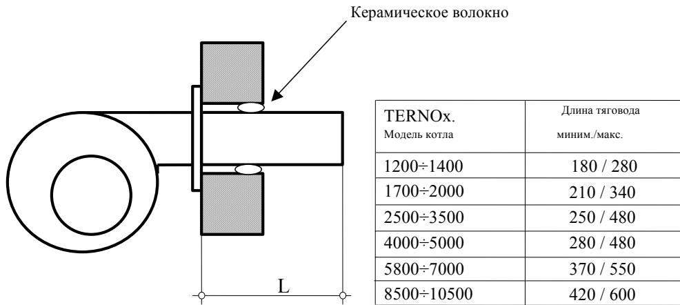
Зафиксировать горелку на двери с помощью крепёжной плиты, чтобы факел был строго горизонтален и располагался по центру топки. При нарушении указываемых условий может наблюдаться плохое горение, ведущее к серьёзной аварии котла.
