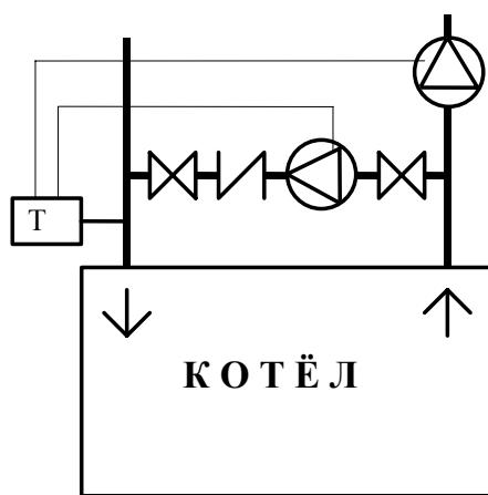
Для избежания образования конденсата правильно наладить изображённую на рисунке систему, чтобы даже ночью поддерживалась постоянная температура в 55 °C, и дополнительно смонтировать термостат ограничения температуры, чтобы исключить подачу воды смесительным клапаном и снижения её температуры ниже 55 °C. Все эти мероприятия гарантируют долговременную работу котла.
