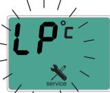
viene visualizzato in modo lampeggiante, al posto dei gradi centigradi Il codice che identifica la causa, (per elenco "codici di errore" vedere par. 4.6 manuale di istruzioni per l'installatore e il manutentore).
