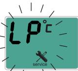
este afișat intermitent, în locul gradelor Celsius, codul de identificare a cauzei, (lista "codurilor de eroare" se află în par. 4.6 al manualului de instrucțiuni pentru instalator și tehnician).
