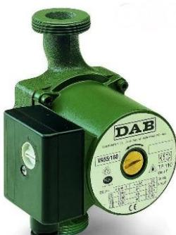
Насосы с мокрым ротором DAB – это моноблоковые насосы, где гидравлическая часть сделана из чугуна, а корпус двигателя штампованного алюминия. Рабочее колесо выполнено из полимера, а вал из нержавеющей стали. Вращается вал в графитовых подшипниках скольжения. Смазкой служит жидкость, которую перекачивают. Из нержавеющей стали так же сделаны другие детали - защитная оболочка ротора, кожух статора, уплотнительный фланец.
