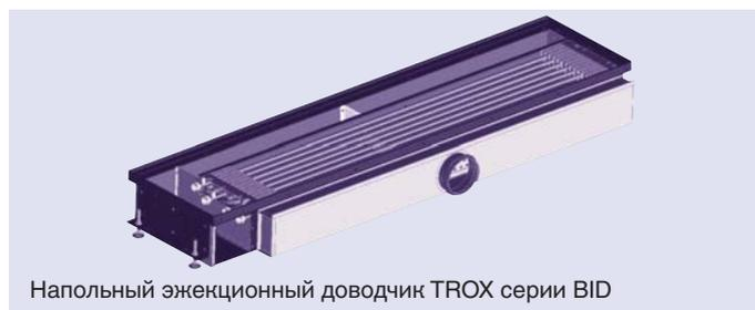
Размер корпуса доводчика предусматривает наличие встроенных регулирующих клапанов, а также приводов, таким образом, данные узлы остаются легко доступными для осмотра или замены. Поставляется три типа сопел, в зависимости от требуемого объемного расхода воздуха. Линейные или жалюзийные решетки можно легко извлечь для очистки.
