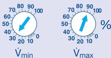
Требуемый расход воздуха устанавливается заказчиком. При установке  $\dot{V}_{\min}$  больше, чем  $\dot{V}_{\max}$ , значение  $\dot{V}_{\min}$  принимается за постоянный расход, даже при подаче сигнала на изменение расхода.
