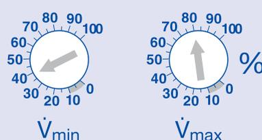
Потенциометр  $\dot{V}_{\min}$  устанавливается в положение 40 %, а  $\dot{V}_{\max}$  – в положение 80 %.
