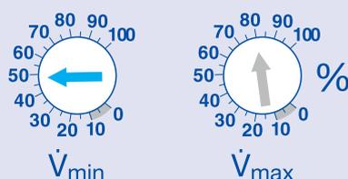
Значение постоянного расхода может быть установлено при помощи потенциометра  $\dot{V}_{\min}$ . Значения потенциометра  $\dot{V}_{\max}$  не учитываются.
