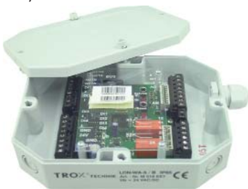
Модуль адаптера LonWorks® LON-WA5/B
