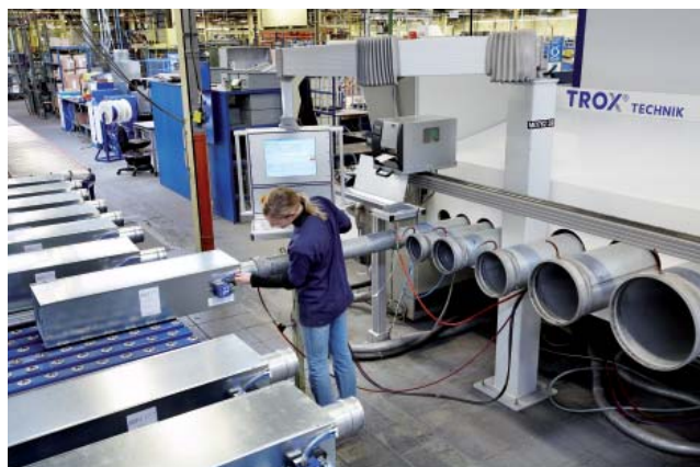
Производство, проверка и калибровка регуляторов расхода на заводе-изготовителе
