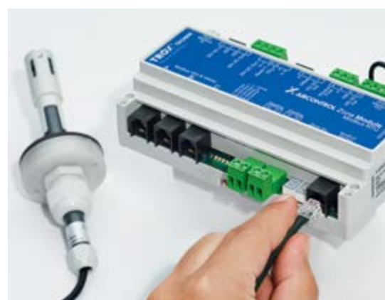
Подключение компонентов по принципу „plug and play“
