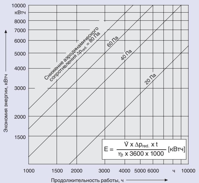
Значения на диаграмме основаны на характеристиках общего коэффициента полезного действия вентилятора  $\eta_t$ , равного 0.8 и объемном расходе воздуха 80000 м<sup>3</sup>/ч.
