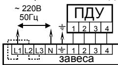
Схема подключения T4,5; T6; T9
