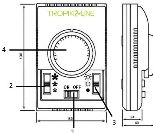
1 – переключатель **ON/OFF** для включения/выключения теплоventилиатора
