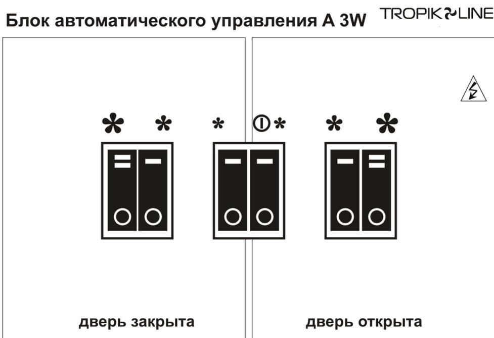
Схема подключения блока автоматического управления А 3W.
