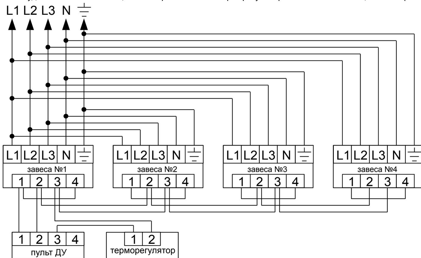
2. Для Т9, Т12, Т109Е, Т112Е. Терморегулятор отключает 1/2 мощности нагрева.
