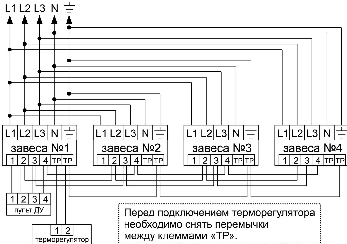
4. Для М3, М6, М9. Терморегулятор отключает часть мощности нагрева.
