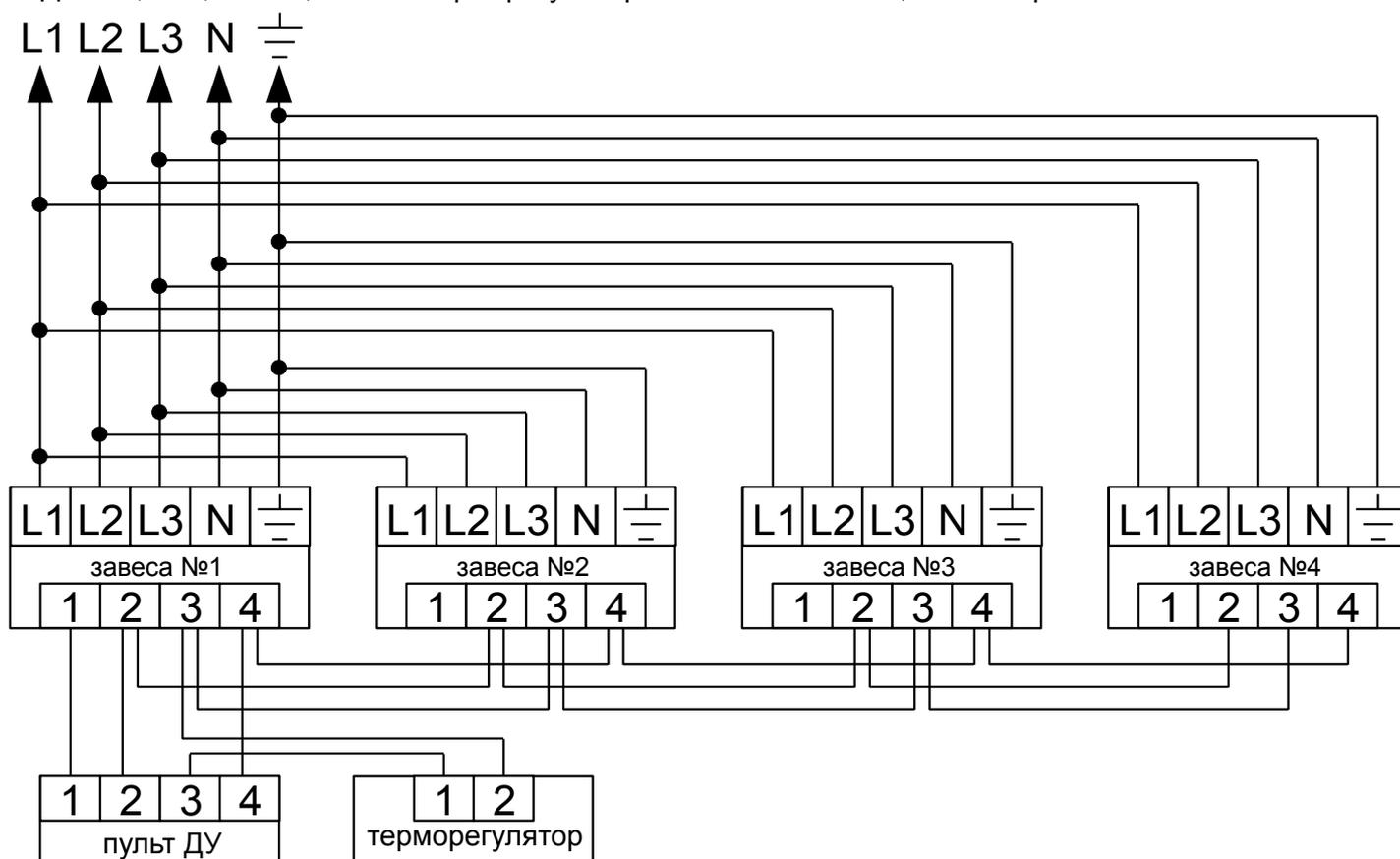
3. Для ЗЭТ9, ЗЭТ12, ЗЭТ18. Терморегулятор отключает всю мощность нагрева.
