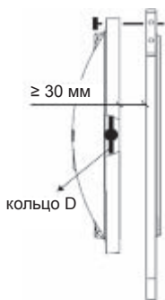
Рисунок 30. Снятие водяной камеры: откидывание, установка грузоподъёмной цепи
