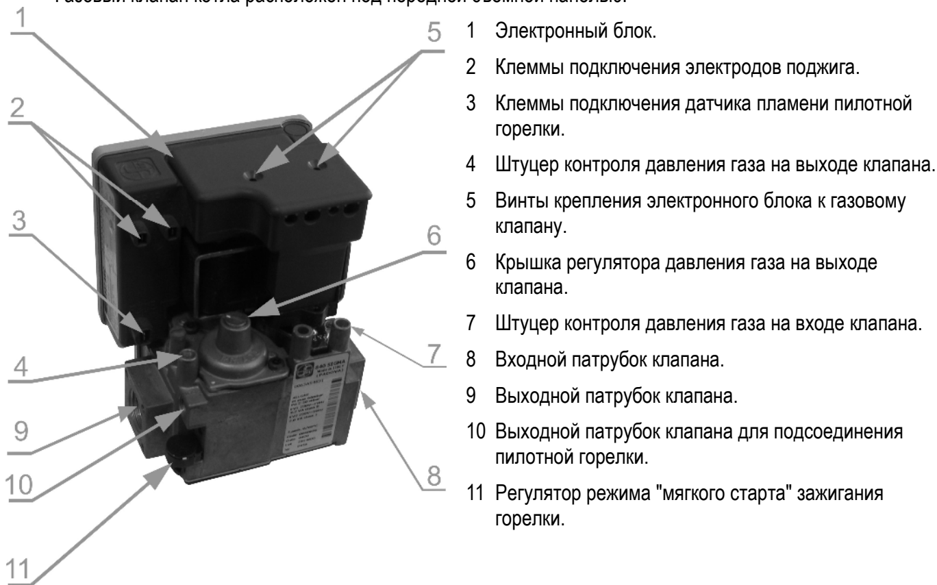
Рисунок 10. Газовый клапан котла с автоматикой.
