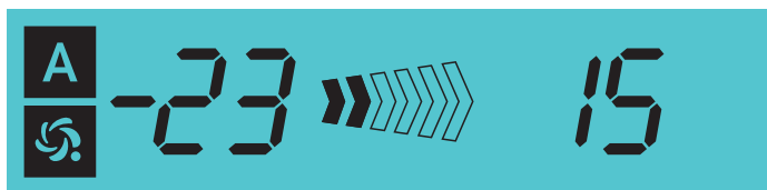
Рисунок 4. Вид ЖК-дисплея, когда прибор соединен с системой MagicAir и находится под ее автоматическим управлением
