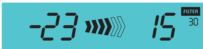
Рисунок 6. Вид ЖК-дисплея, когда прибор находится в режиме ручного управления и приближается срок замены фильтров
