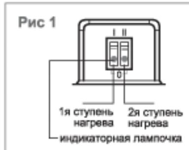
Водонагреватель оснащен следующими контрольно - управляющими устройствами:
