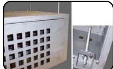
На верхней части корпуса расположены отверстия под резьбовые стержни M10 (4 отверстия для моделей длиной 1 м и 6 отверстий для моделей длиной 1,5 и 2 м - см. Рис. 1 или Рис. 2) для подвесного монтажа завесы. Вставить резьбовые стержни в данные отверстия и закрепить их на кронштейне в нижней части завесы. Завесы типоразмеров 1,5 и 2 м должны подвешиваться на все шесть точек крепления.
