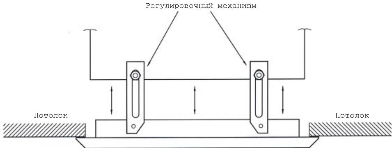
Рисунок 2 – Регулирование высоты установки решетки
