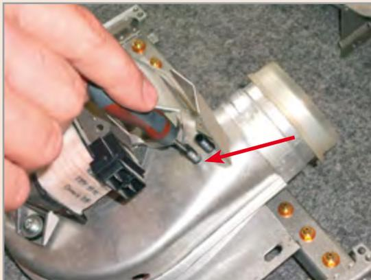
**12.4** С помощью малой отвертки или иного тонкого инструмента очищаем измерительные входы на трубке Вентури (должны быть проходимы).
