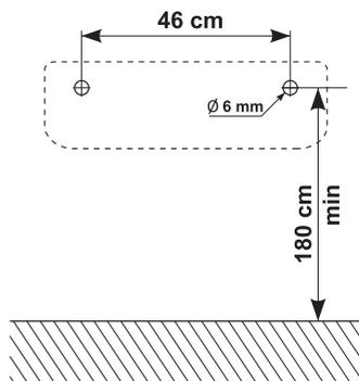
2. A altura de 1.8m do chão abra dois orifícios de F6mm na parede a uma distância de 46cm um do outro. Certifique-se de que o diâmetro dos orifícios é o mesmo das buchas de plástico
