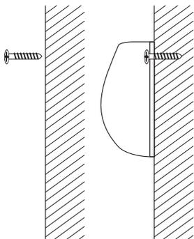
3. Поставьте и вкрутите оба винта в дюбели так, что головки винтов осли 15мм вне стены. Убедитесь что винты достаточно прочно закреплены в стену и тогда можете повесить прибор.
