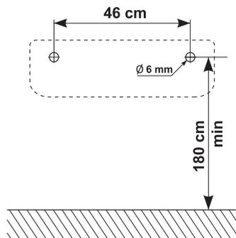
2. Izstīiet 2 montāžas caurumus, 6 mm dziļus, 1,8 m augstumā no grīdas un 46 cm attālumā vienu no otra. Pārlicinieties, ka caurumu diametrs atbilst plastmasas dibējiem.
