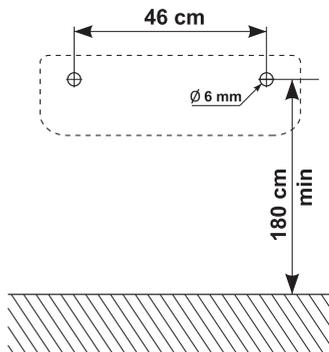
2. На высоте 1.8м от пола сверлите два отверстия  $\Phi$  6мм в стене на расстояние 46см друг от друга. Убедитесь, что диаметр отверстия тот же самый как пластмассовый дюбель
