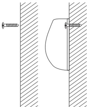
3. Coloque e aparafuse os dois parafusos nas buchas de forma que as cabeças dos parafusos fiquem a 15 mm de fora. Certifique-se de que os parafusos estão suficientemente bem fixos à parede e coloque o aparelho.
