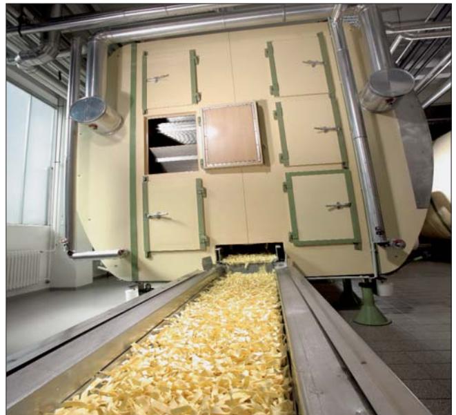
Качественная сушка макаронных изделий благодаря оптимальному измерению уровня влажности
