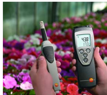
Наконечник зонда влажности подсоединяется к прибору с помощью кабеля, для мониторинга на соответствие климатических нормам
