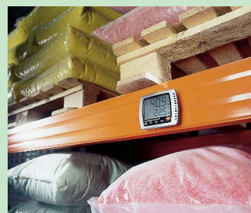
Точный мониторинг условий хранения на складах с погрешностью ±2% OB
