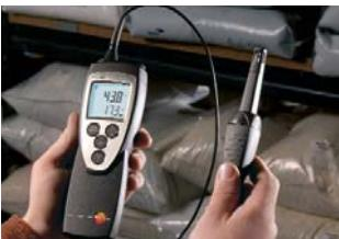
**Прибор для измерения относительной влажности и температуры testo 625**
