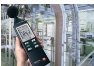
**Шумомеры Второго класса точности testo 816, testo 815**
