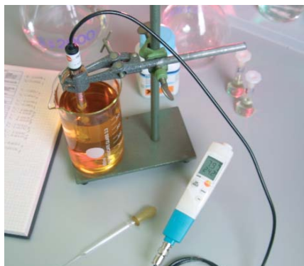
testo 206-pH3 обеспечивает подключение внешних зондов
