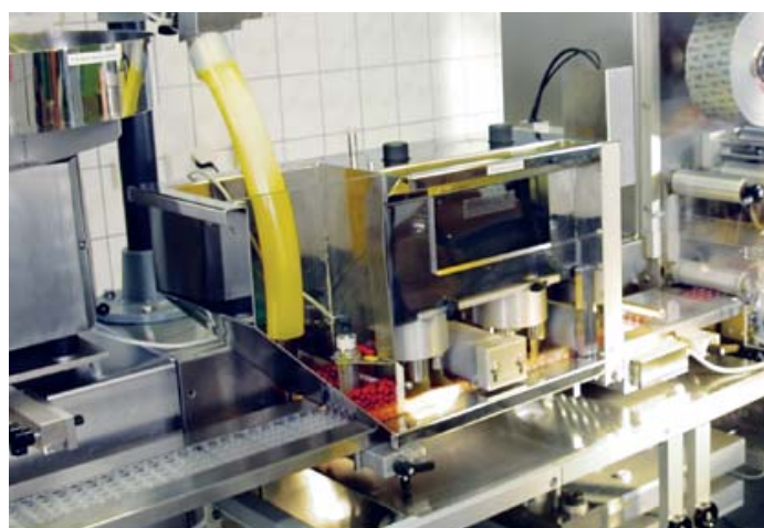
Положительное давление в уровнях заполнения помогает поддерживать гигиеничные условия при фасовке (дозировке) в пищевой промышленности и фармацевтике
