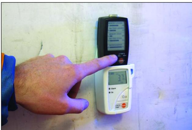
Карманного размера testo 580 - коллектор данных переносит данные с логгеров закрепленных на месте замера для загрузки на ПК
