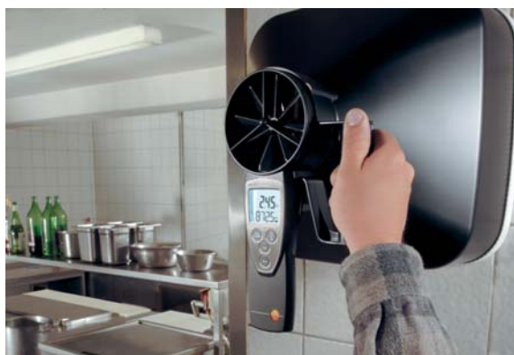
testo 417, используется, например, для мониторинга отработанного воздуха в настенных вентиляторах
