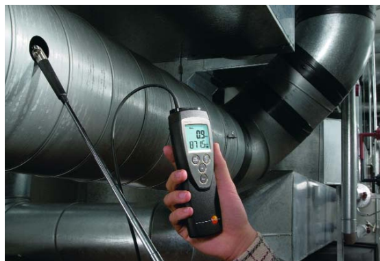
testo 416, используется, например, для мониторинга объемного расхода отработанного воздуха в системах вытяжной вентиляции
