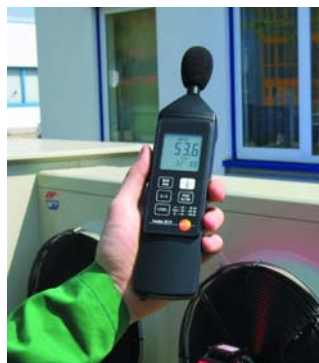
testo 815, мониторинг уровня шума в системах вентиляции
