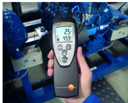
Одновременное измерение с testo 922 перегрева и переохлаждения в холодильных системах
