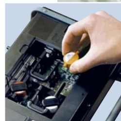
Измерительные ячейки могут быть заменены пользователем легко и быстро по месту замера
