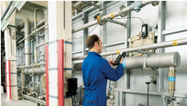
testo 350 S: Комплект для быстрого мониторинга выбросов на промышленных горелках (O 2 , CO, NO)
