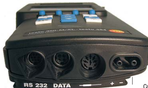
соединение с шиной данных Testo Подключение дополнительных зондов Соединение для измерения дифференциального давления/скорости потока Соединение RS232
