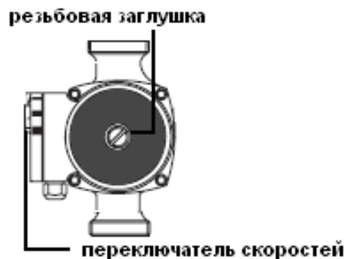
Рис.8. Положение резьбовой заглушки отверстия для удаления воздуха и переключателя частоты вращения.
