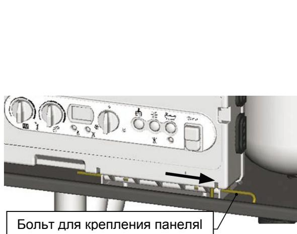
Рис. 8. Болт для крепления панеля
