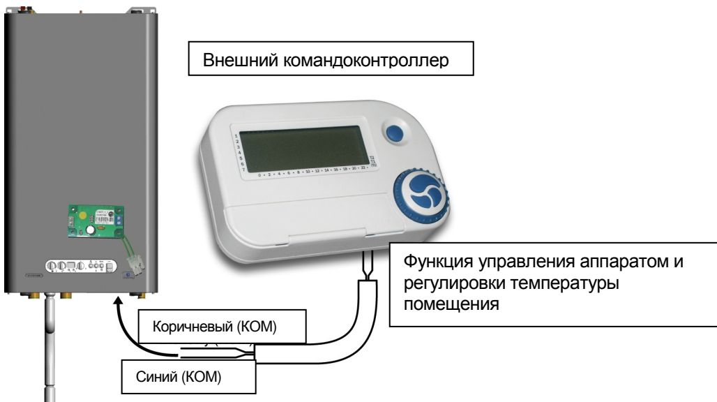
Рис. 12 Подключение внешнего командоконтроллера – одна зона
