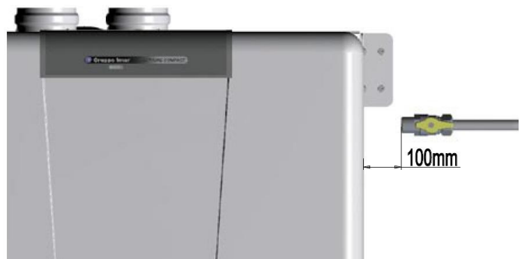
Рис. 6. Подключение к главному газовому
