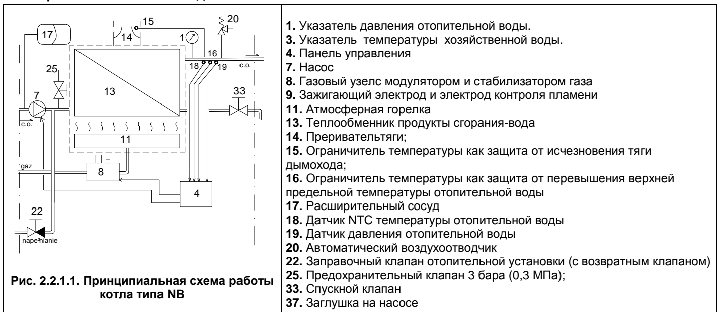
Рис. 2.2.1. Главные узлы котла типа NB
