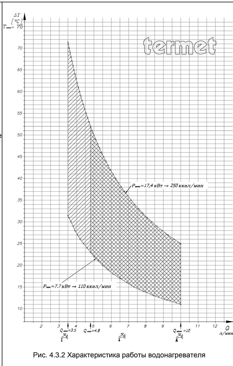
Рис. 4.3.2 Характеристика работы водонагревателя
