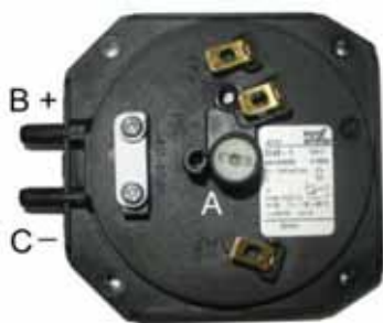
„А” – винт регулирования давления „В+” – наконечник для измерения избыточного давления „С-” – наконечник для измерения вакуумметрического давления
