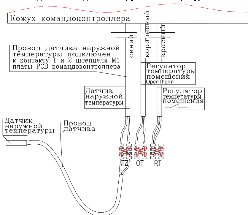
Рис.3.11.1. Подключение датчика наружной температуры
