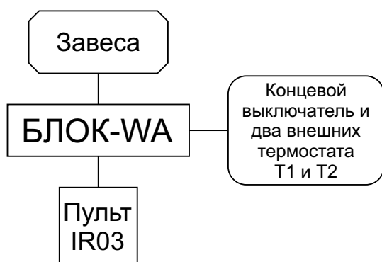
Рисунок 3. Структурная схема подключения одной завесы через БЛОК-WA
