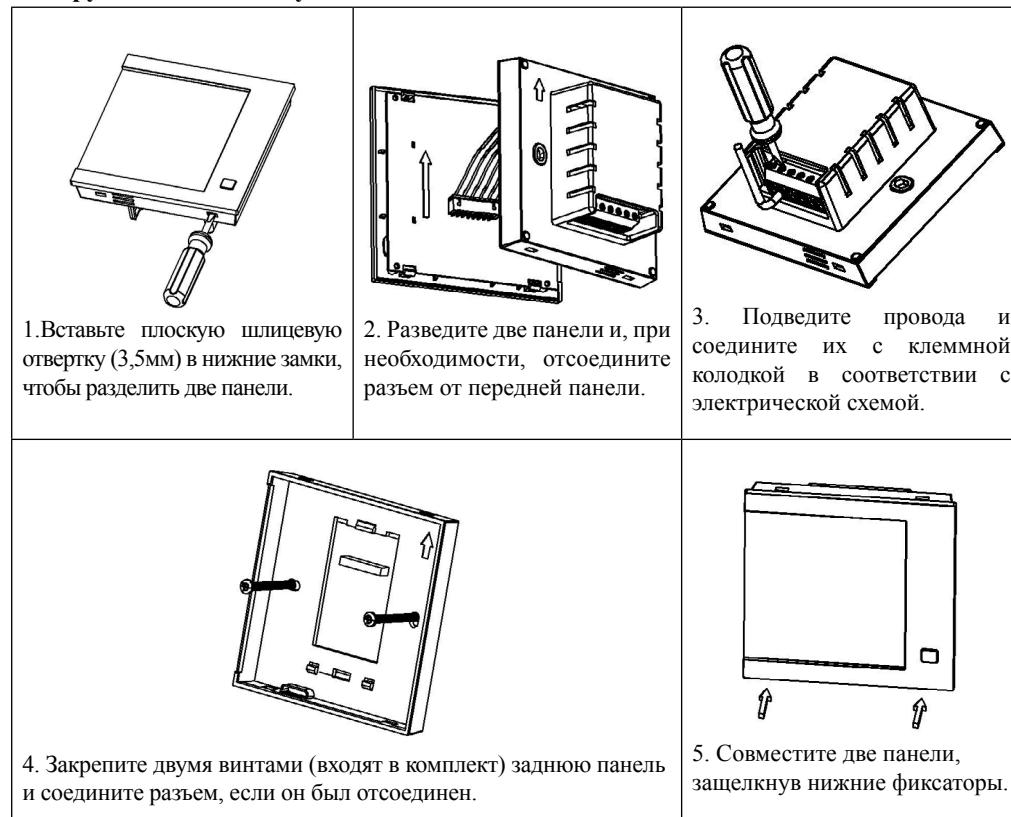
**ПРИМЕЧАНИЕ:** Убедитесь, что провода были подключены в точном соответствии с электрической схемой пульта и не подвергайте их воздействию грязи, воды или других материалов, чтобы исключить возможность порчи проводов.
